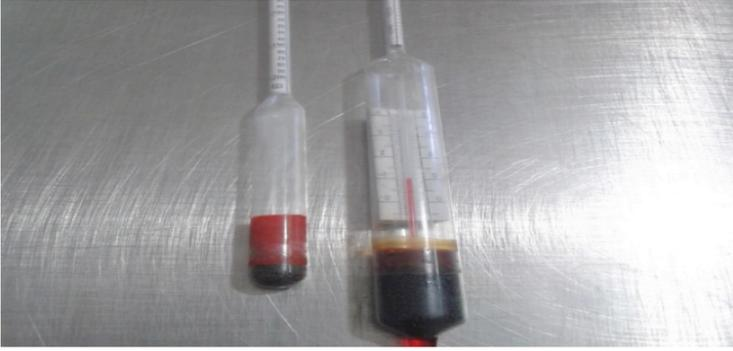
شكل (٢) جهاز فحص كثافة الحليب (Lactometer)
