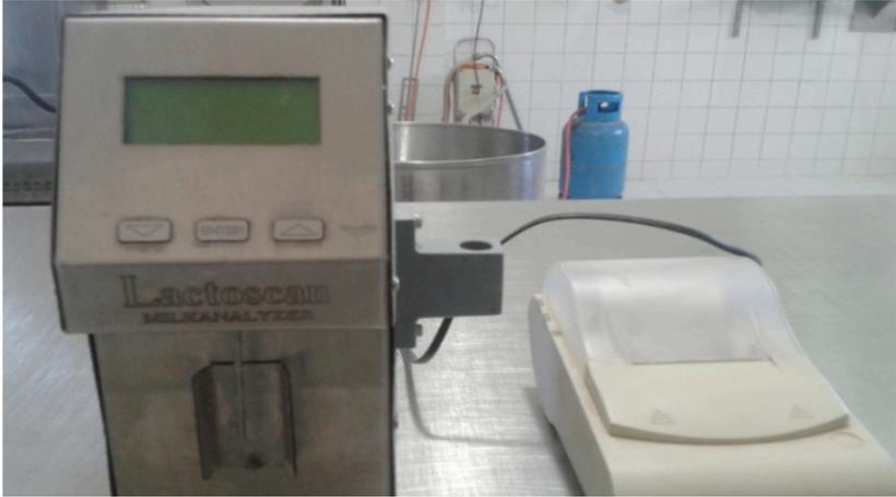
شكل (١) جهاز فحص مكونات الحليب (Lactoscan)
